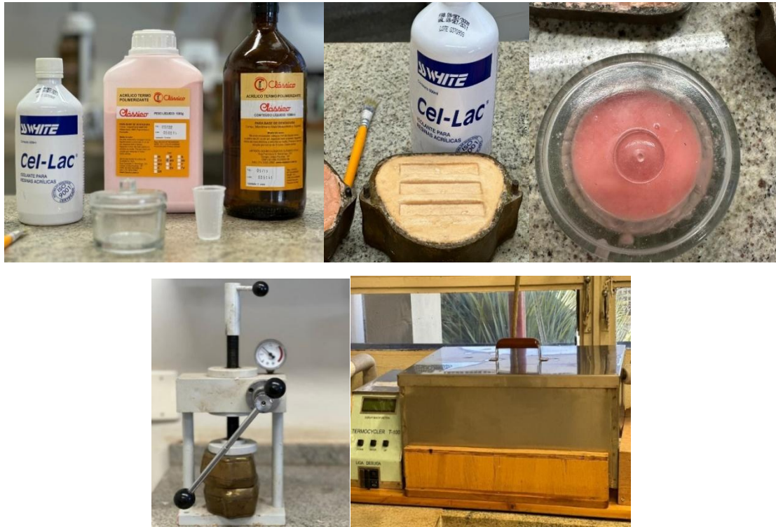
Figura 1. Etapas da confecção dos corpos de prova em resina acrílica termopolimerizável
