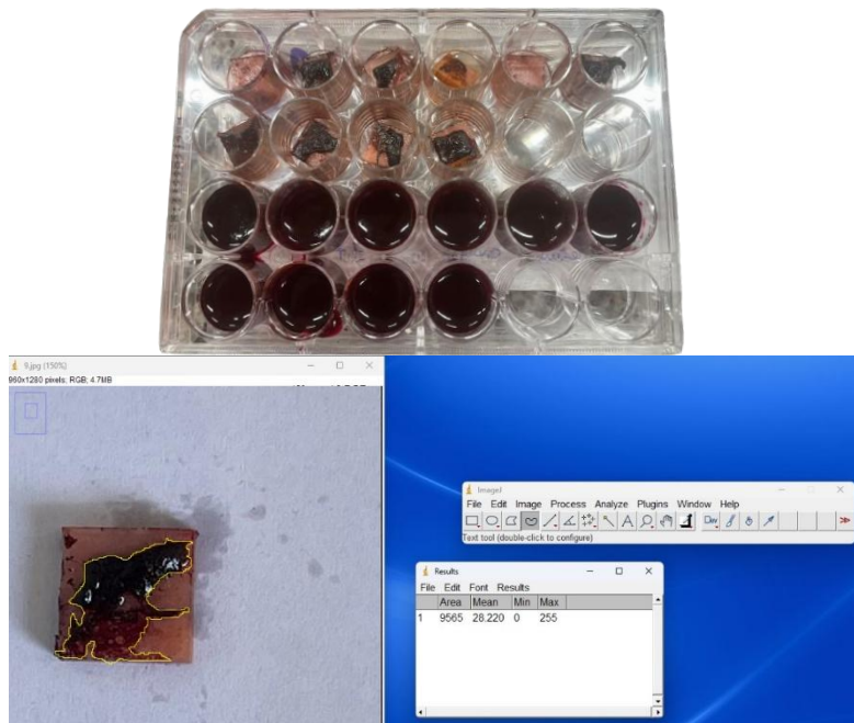
Figura 6. Amostras imersas em corante e quantificação do adesivo remanescente no Software Imaje J.
