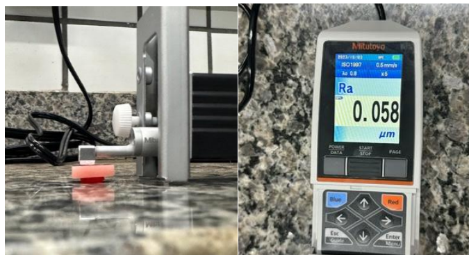
Figura 3. Análise da rugosidade superficial das amostras em rugosímetro
