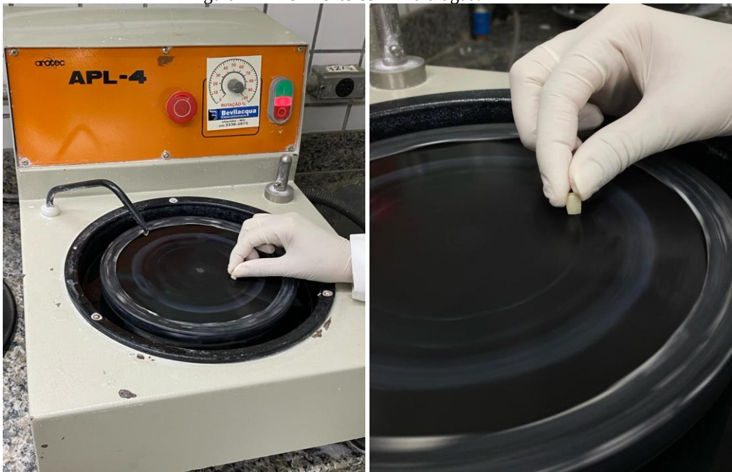
Figura 12 – Polimento com lixa d'água.
