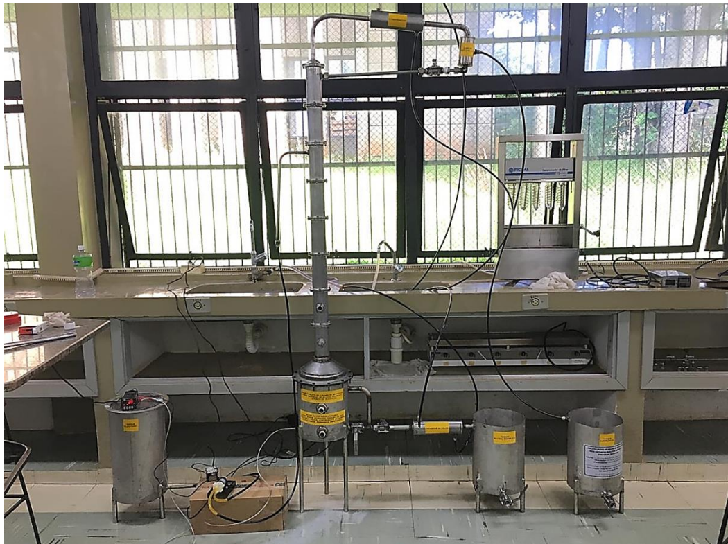
Figura 33: Coluna de destilação montada
