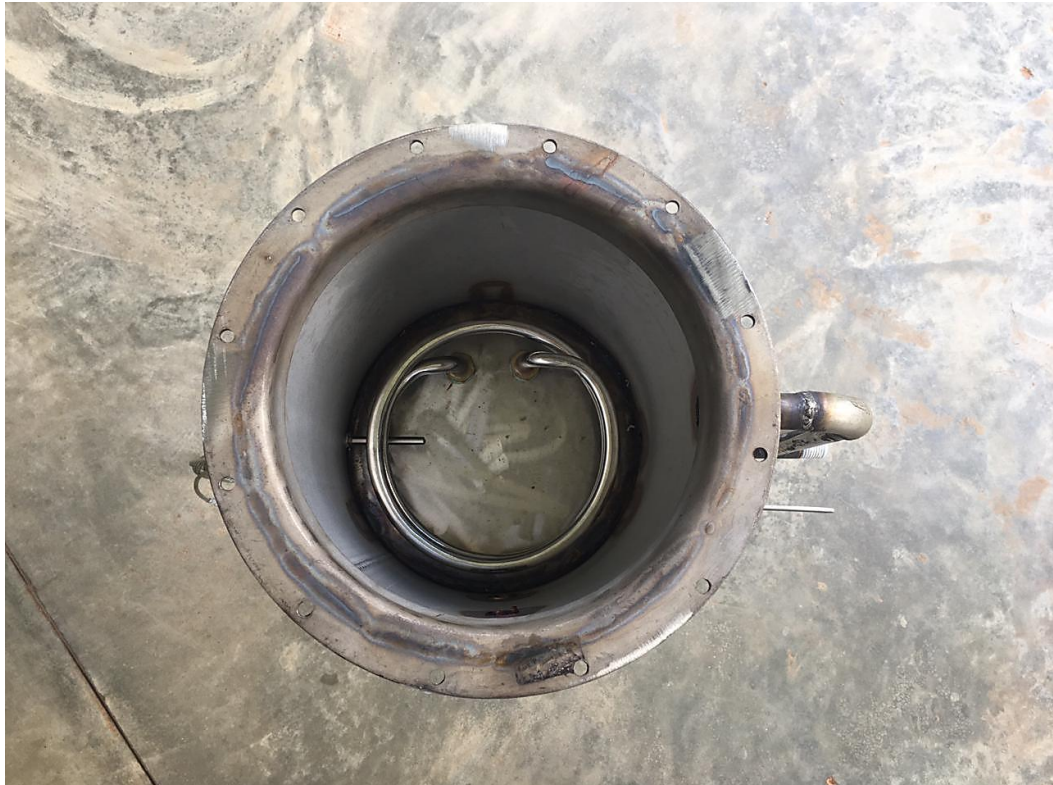
Detalhe da resistência elétrica na base da coluna
