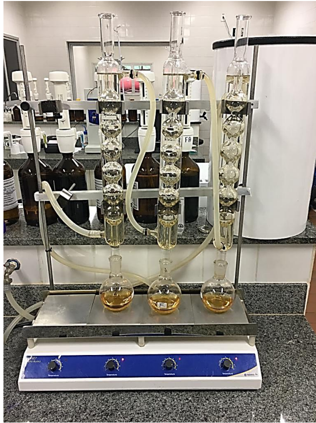
Figura 35: Sistema de refluxo utilizado para a síntese do acetato de isoamila
