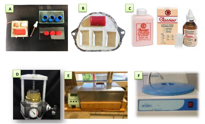
**Figura 2.** Confecção dos espécimes em resina acrílica. A- Preparação das matrizes em cera, B- Moldes dos espécimes prontos, C- Resina acrílica utilizada, D- Prensagem em prensa hidráulica, E- Termocicladora elétrica, F- Politriz utilizada para acabamento e polimento dos espécimes.
