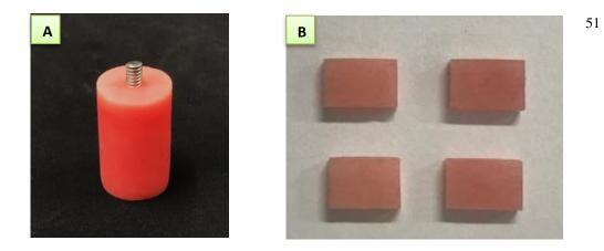
**Figura 3.** A- Espécime cilíndrico em resina acrílica; B- Espécimes retangulares em resina acrílica.
