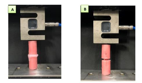
**Figura 9.** A. Compressão Prévia na Máquina de Ensaios Universal; B- Teste de Tração na Máquina de Ensaios Universal.
