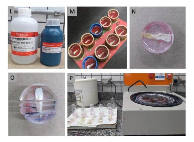
Figura 2 – Preparação dos espécimes para análise da microdureza. L: Resina Epóxi usada para inclusão dos espécimes; M: Inclusão dos espécimes com resina epóxi em dispositivo de PVC;
