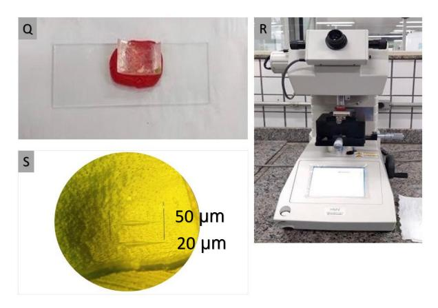
**Figura 3** – Análise da microdureza. **Q:** Colocação da amostra paralela a uma placa de vidro para análise no microdurômetro. **R:** Microdurômetro utilizado para análise da microdureza dentinária. **S:** Análise da microdureza dentinária após identação na amostra nas profundidades de 20 µm e 50 µm.
