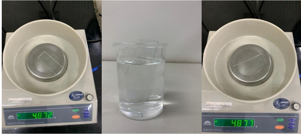
Figura 13: Teste de resistência à água para a base pronta incolor. Massa inicial (a esquerda) imersão da lâmina contendo a base em água (no centro) e massa final (a direita). Fonte: Próprio autor, 2020.
