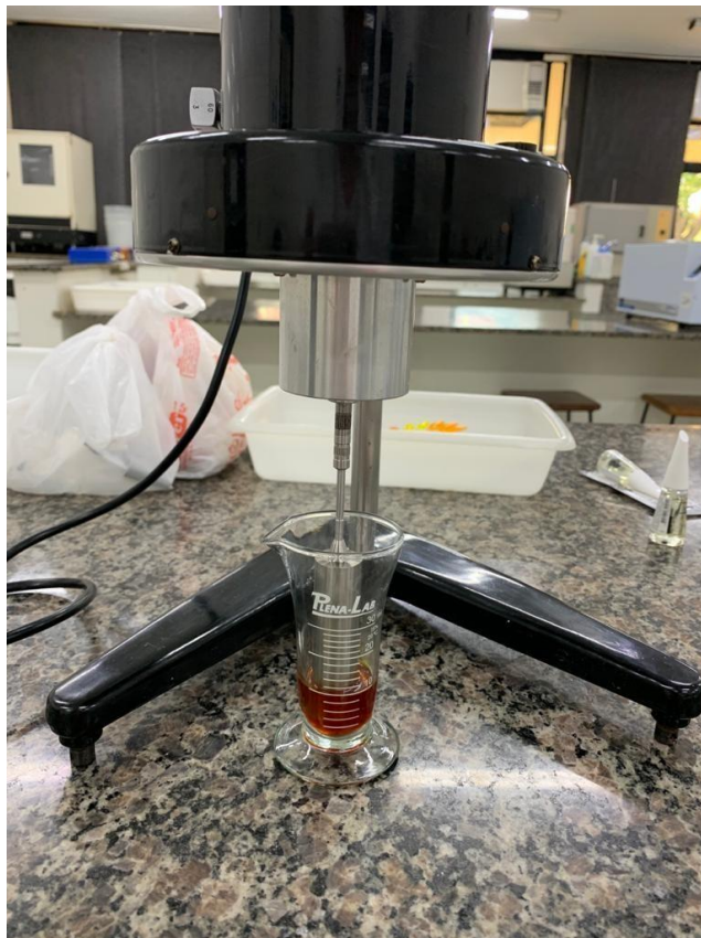
Figura 12: Avaliação da viscosidade no esmalte contendo pigmento de urucum. Fonte: Próprio autor, 2020.
