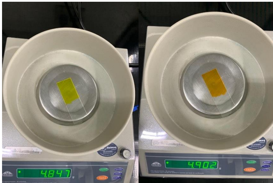
Figura 14: Teste de resistência à água para o esmalte contendo pigmento açafão e urucum - massa inicial do esmalte com pigmento de açafão (a esquerda) e massa inicial do esmalte com pigmento de urucum (a direita). Fonte: Próprio autor, 2020.
