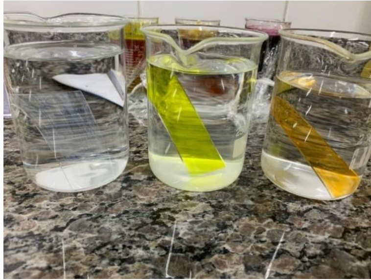
Figura 18: Teste de aspecto para base pronta (a esquerda) e para os esmaltes contendo pigmentos naturais de açafrão (no centro) e urucum (a direita). Fonte: Próprio autor, 2020.
