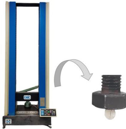
**Figura 14** - Máquina universal de ensaios.
