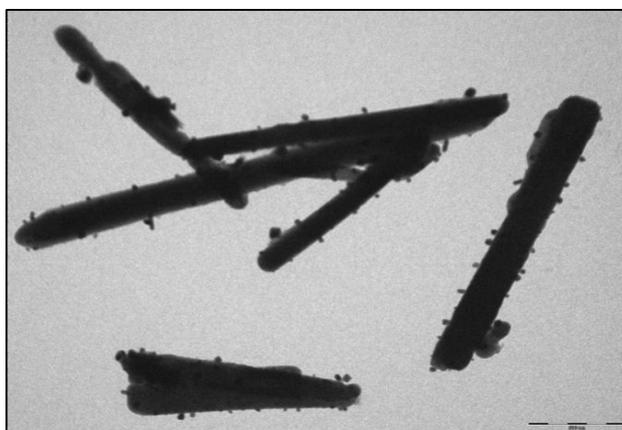
**Figura 17** - Microscopia eletrônica de transmissão do vanadato de prata nanoestruturado decorado com nanopartículas de prata (x 200 magnitude).
