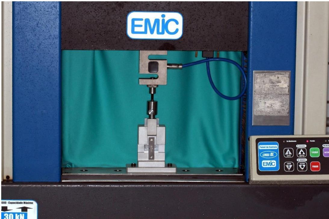
**Figura 15** - Máquina de ensaio biomecânico EMIC modelo DL-3000.
