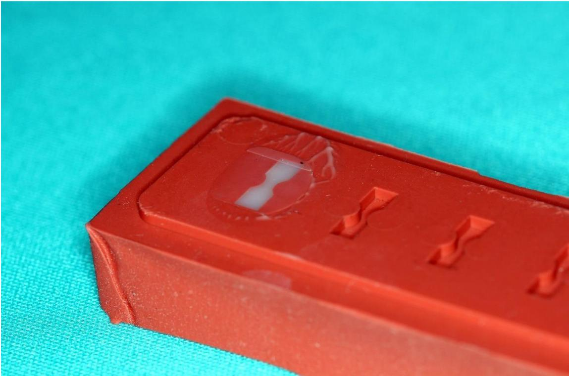
**Figura 9** – Corpo-de-prova após foto ativação.
