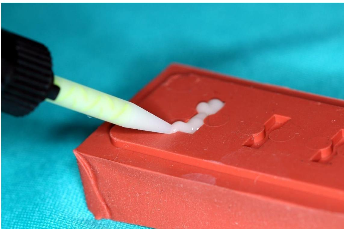
**Figura 6** – Inserção do cimento de auto mistura no molde de silicone.
