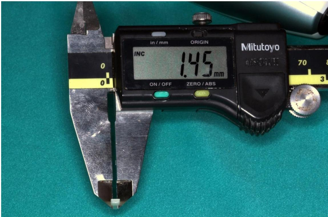
**Figura 13** – Paquímetro digital.
