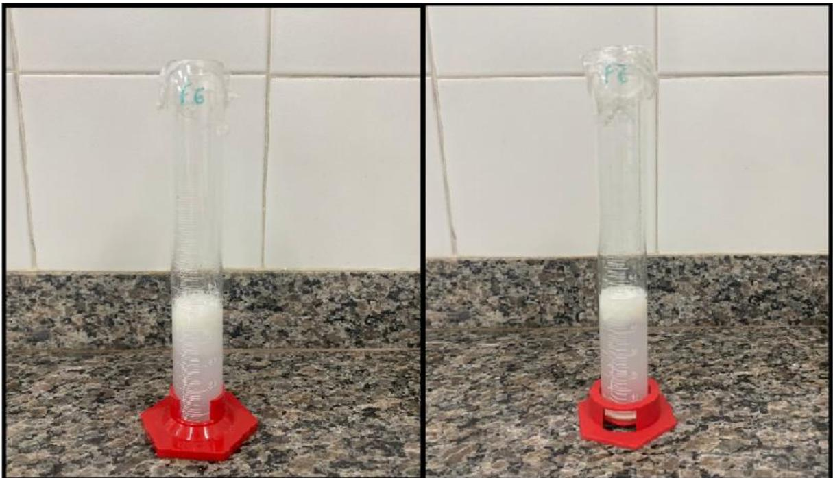
**Figura 3:** Representação da realização do teste de formação (à esquerda) e estabilidade (à direita) da espuma das diferentes formulações de shampoo em barra.
