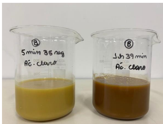
Figura 5: Produto B com diferente velocidade de dosagem do ácido fosfórico.
