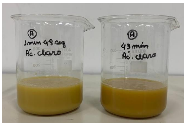
Figura 3: Produto A com diferente velocidade de dosagem do ácido fosfórico.
