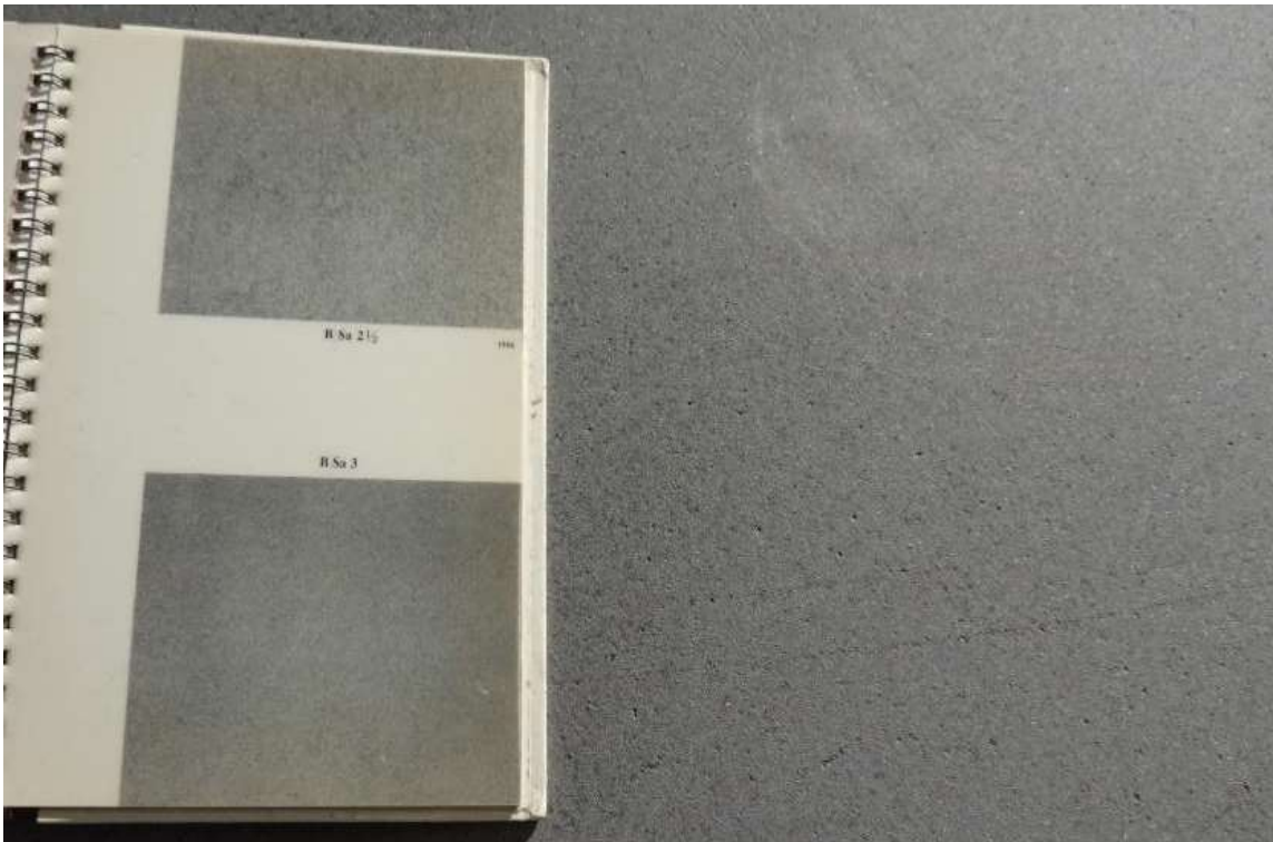
Figura 2 - Padrão visual de chapa de fundo após jateamento
