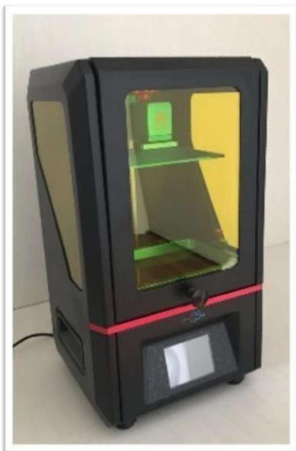
A impressora Photon utiliza a tecnologia de impressão DLP (processamento de luz direta) por meio de uma luz UV cujo comprimento de onda é de 405nm, a impressora Photon suporta apenas resina fotossensível (recomendado usar resina UV 405 nm).
