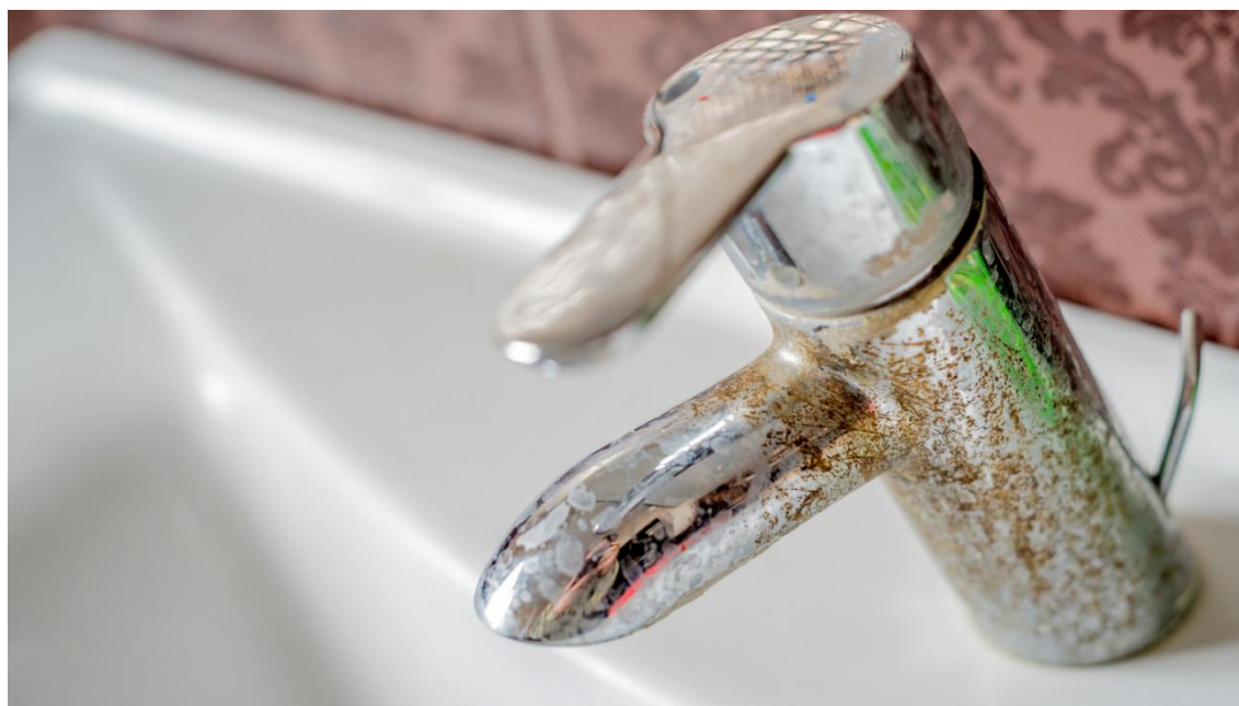
Figura 1.3 Torneira com incrustação – excesso de cácio na água www.blog.purific.com.br
