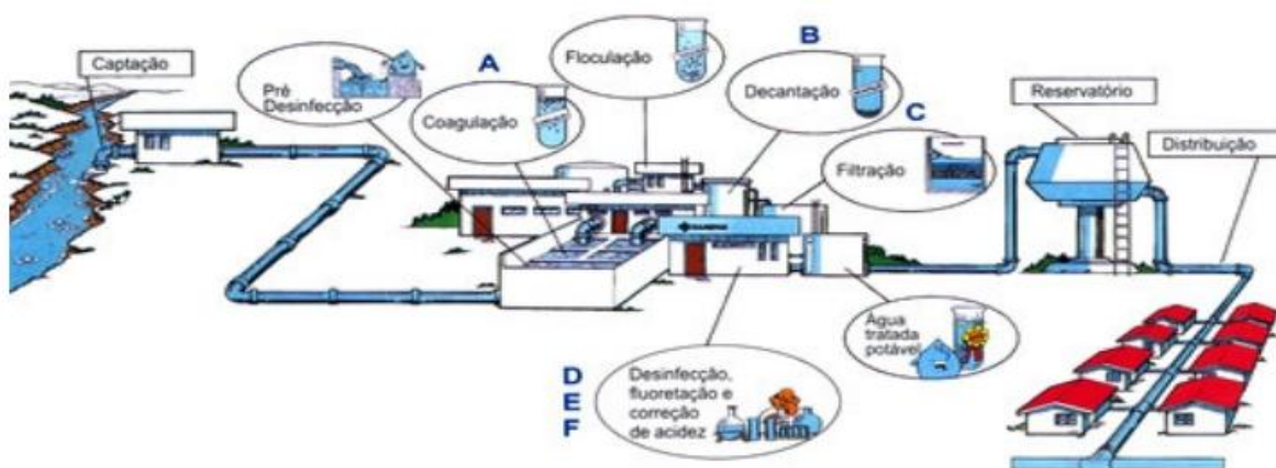
Figura 1.1. Tratamento Convencional de água ((FRANCISCO e POHLMANN, 2011).
