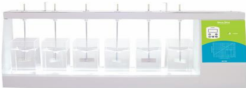
Figura 4.1 . Vista e esquema do Jar Test.
