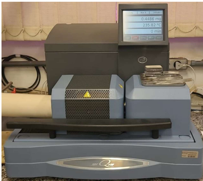
Figura 9. Análise termogravimétrica (TGA) realizada no equipamento SDT Q600, TA Instruments.
