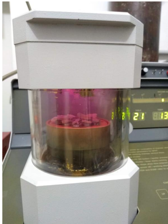
Figura 17: Processo de metalização das amostras com partículas de ouro.
