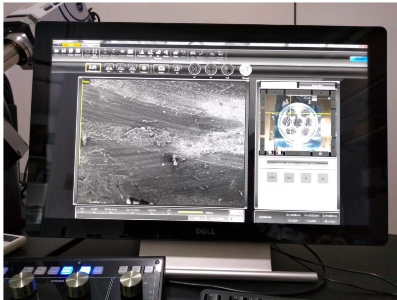
Figura 19: Análise qualitativa do grau de limpeza através de microscópio eletrônico de varredura da Escola Superior de Agricultura Luiz de Queiroz (USP- ESALQ). Fonte: Arquivo pessoal, 2018.
