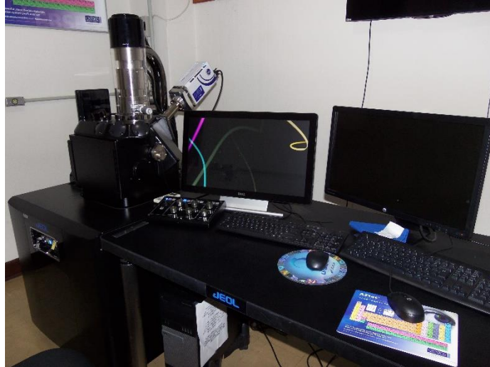
Figura 18: Microscópio eletrônico de varredura da Escola Superior de Agricultura Luiz de Queiroz (USP- ESALQ). Fonte: Arquivo pessoal, 2018.
