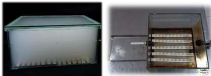
Figura 4. Caixa de vidro para exposição dos dentes à fumaça
