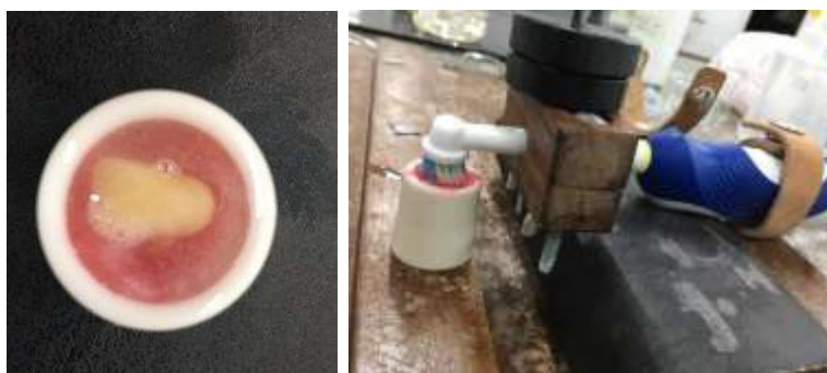
Figura 7. Dente artificial imerso em solução de sabão neutro. Escova acoplada ao suporte fixo padronizado realizando escovação.
