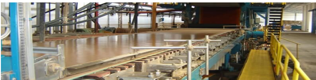
Figura 13: Mesa formadora (MENDES, 2006)
