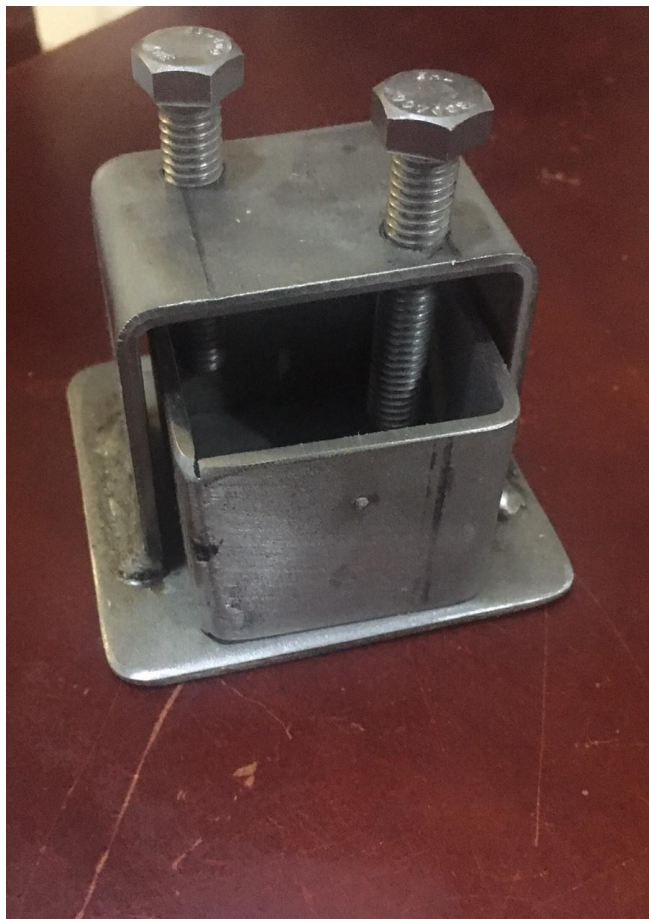
Figura 2- Prensa manual de aço inox
