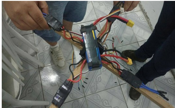
Figura 6 – Posicionamento da bateria e dos ESC
