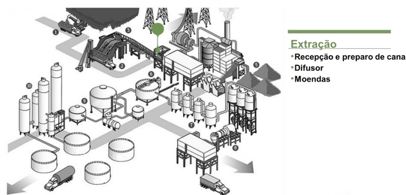
Figura 5 - Etapas do processo em uma usina de cana-de-açúcar.
