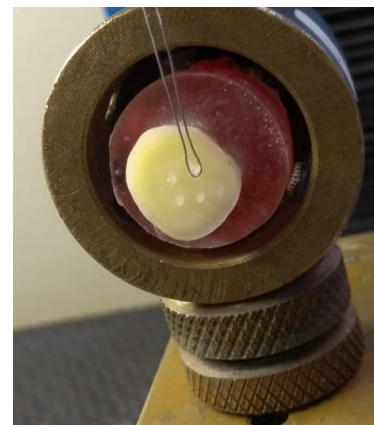
Figura 7: Posicionamento da amostra para o teste de microcisalhamento. Vista frontal.
