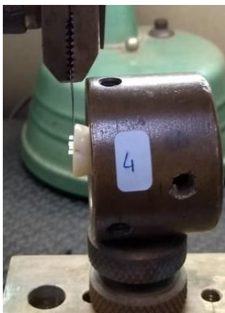
Figura 6. Posicionamento da amostra para o teste de microcisalhamento. Vista lateral.
