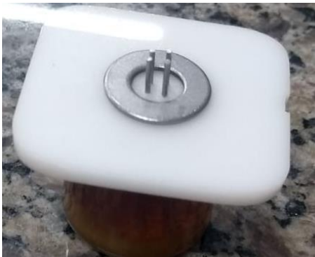
Figura 3. Dispositivo/molde da matriz de silicone.
