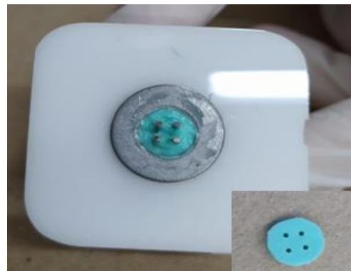
Figura 4. Molde removido do dispositivo após a polimerização do silicone.
