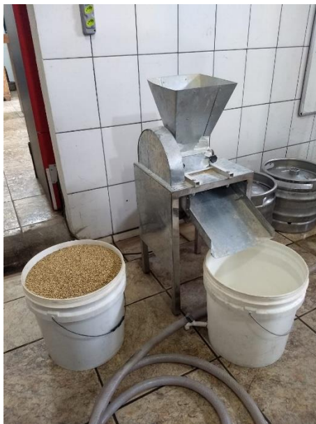
Figura 13: Moedor elétrico pronto para receber os grãos Fonte: Acervo do autor (2020)
