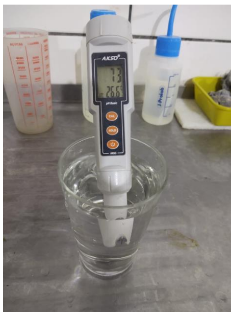
Figura 18: Teste de PH 1 Fonte: Acervo do autor (2020)
