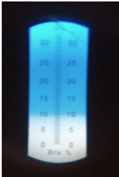
Figura 33: Primeiro teste de densidade Fonte: Acervo do autor (2020)
