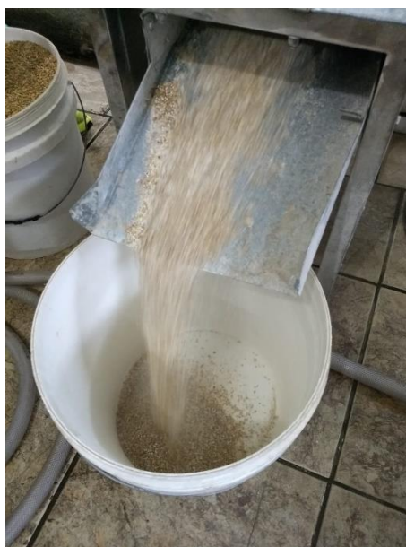
Figura 14: Maltes em processo de moagem Fonte: Acervo do autor (2020)
