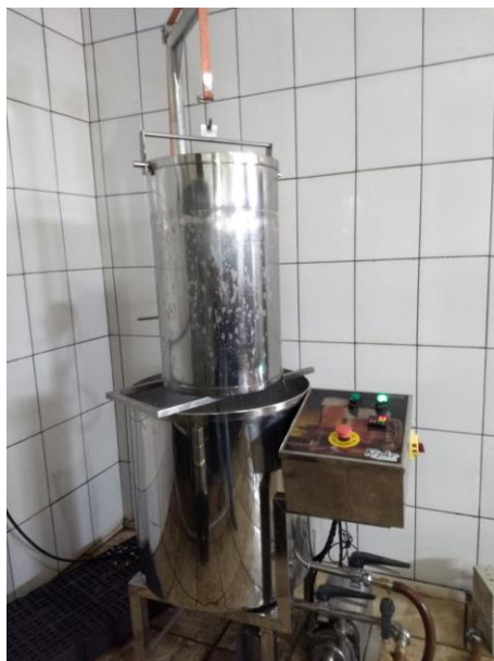
Figura 30: Malte suspenso pelo mecanismo da panela Fonte: Acervo do autor (2020)
