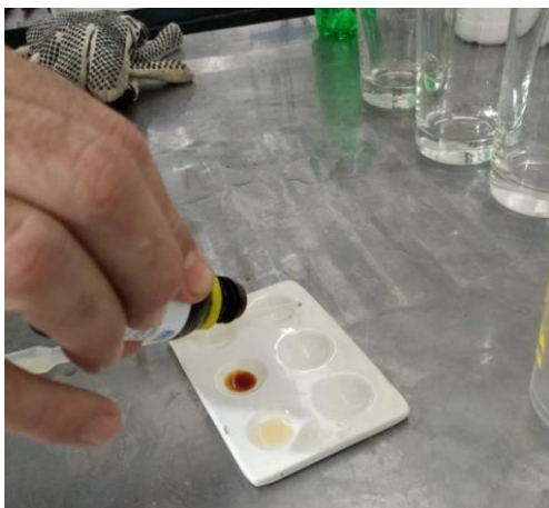
Figura 29: Teste de iodo Fonte: Acervo do autor (2020)
