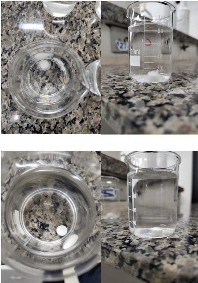
Figura 6: Processo de intumescimento das matrizes hidrofílicas contendo carbopol (acima) e HPMC (abaixo).
