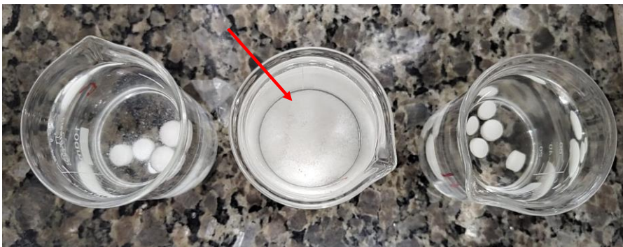
Figura 5: Comportamento em água das matrizes hidrofílicas compostas por carbopol (à esquerda), natrosol (no centro) e HPMC (à direita). A seta indica a instantânea e completa desintegração das matrizes hidrofílicas contendo natrosol.
