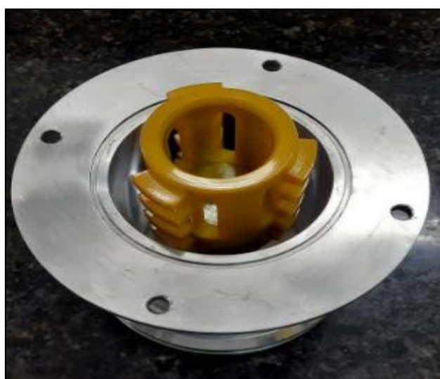
Figura 31 - Câmara de micronização com rotor de pinos
