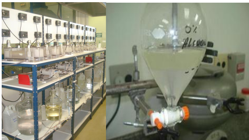
Figura 6: Células de Extração por Solvente Contínua e Ensaio de Extração por Solvente Descontínuo em Laboratório
