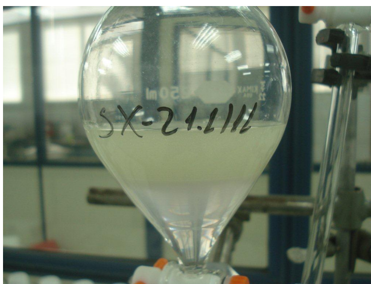
Figura 7: Funil de separação fase aquosa e fase orgânica Fonte: Arquivo do Autor 2017
