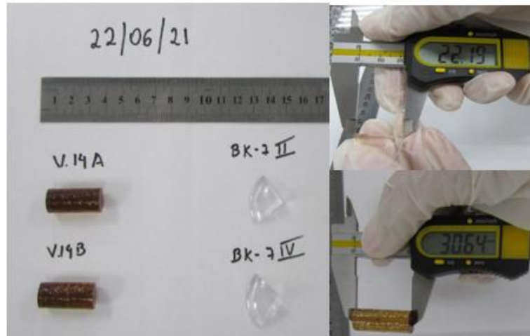
Figura 18 – Vidros Antes do Início dos Testes de Corrosão e Demonstração da Etapa de Medida das Dimensões para Cálculo da área Superficial das Peças Vidro 14 e BK7 Fonte: Arquivo particular da autora (2021).
