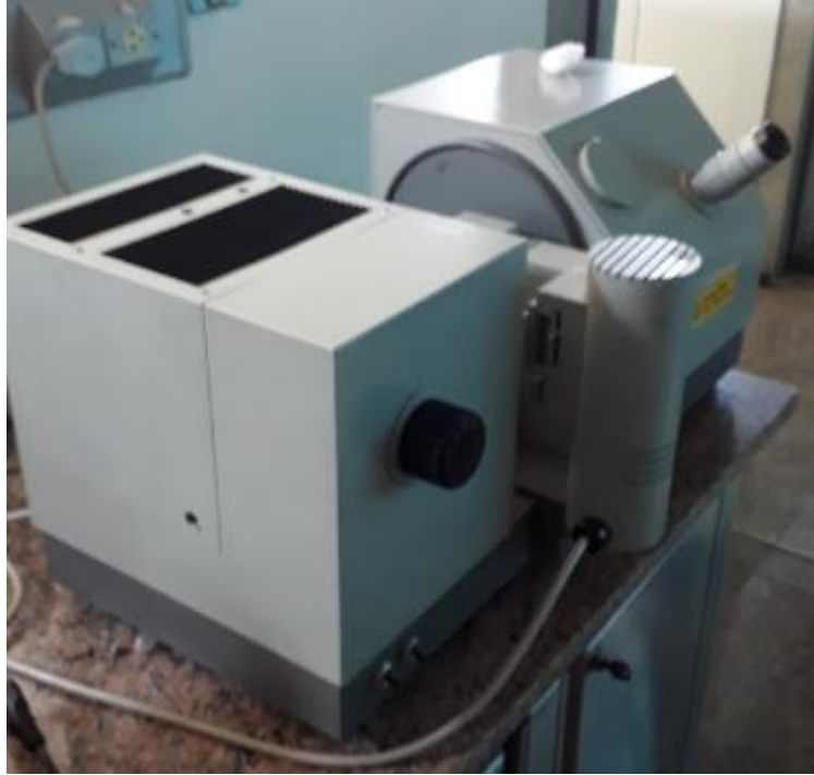
Figura 17 – ABBE-PULFRICH da empresa Zeiss Fonte: Arquivo Particular da Autora (2021).
