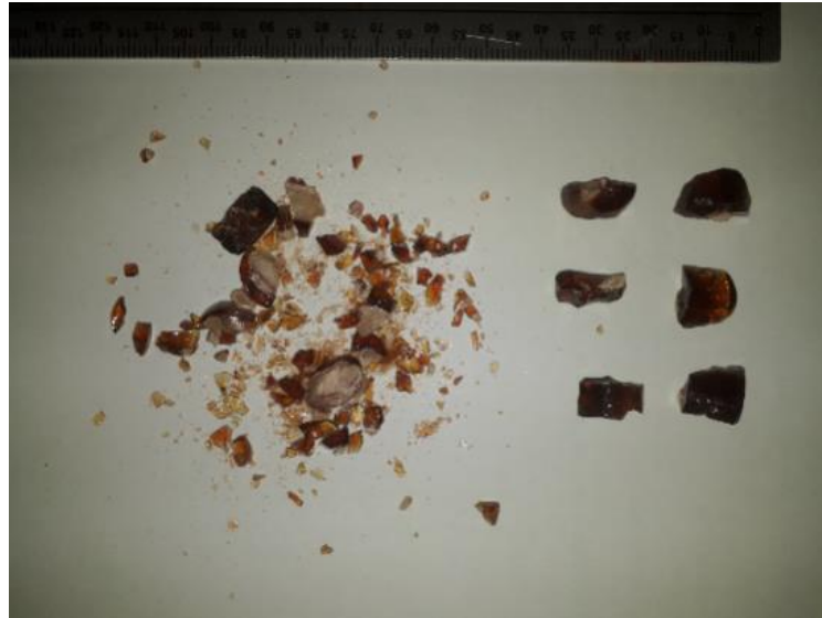
Figura 29 – Vidro 15 onde toda a %mol de Nióbio da Formulação do Vidro 14 foi Substituída por Lantânio
