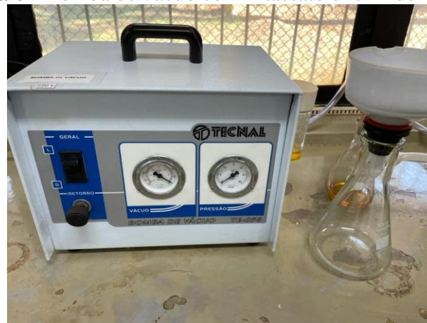
Figura 8 - Bomba de vácuo com kitassato e funil de Buchner
