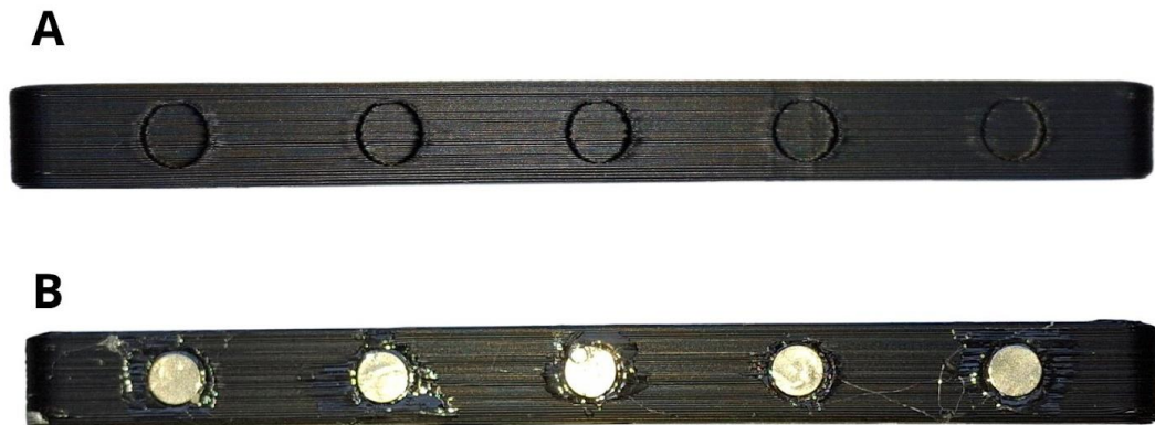
Figura 20 - Visão lateral do Soroban com os cortes para a aglutinação dos ímãs.
