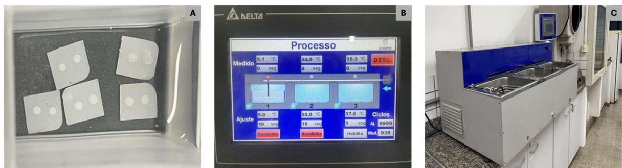
Figura 9. Armazenamento e envelhecimento dos espécimes. (A) Imersão em água destilada, (B) configurações de envelhecimento térmicos dos espécimes cerâmicos e (C) máquina de simulação do envelhecimento térmico. Fonte: arquivo pessoal.
