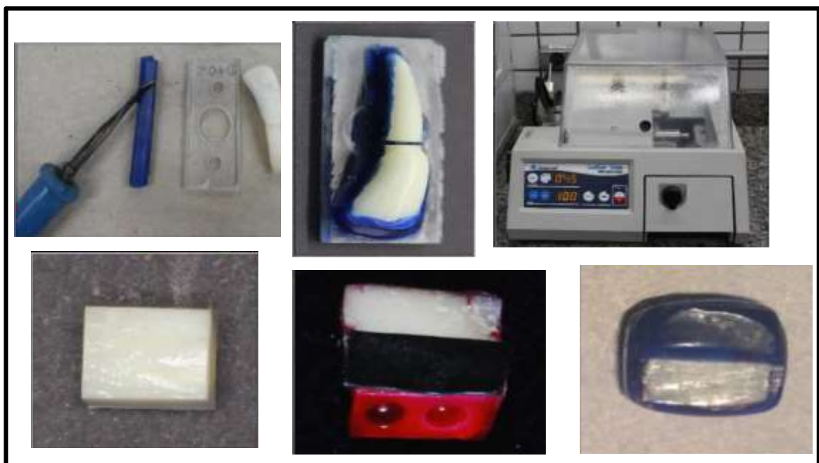
Figura 2. Preparo dos espécimes. A) Gotejador elétrico e cera para fixar o dente na placa acrílica. B) Dente fixado com cera para escultura. C) Máquina de corte - ISOMET® 1000. D) Espécime padronizado. E) Espécime após 3ª camada de esmalte. F). Após aplicação da cera - Espécime pronto para ser submetido ao desafio erosivo.
