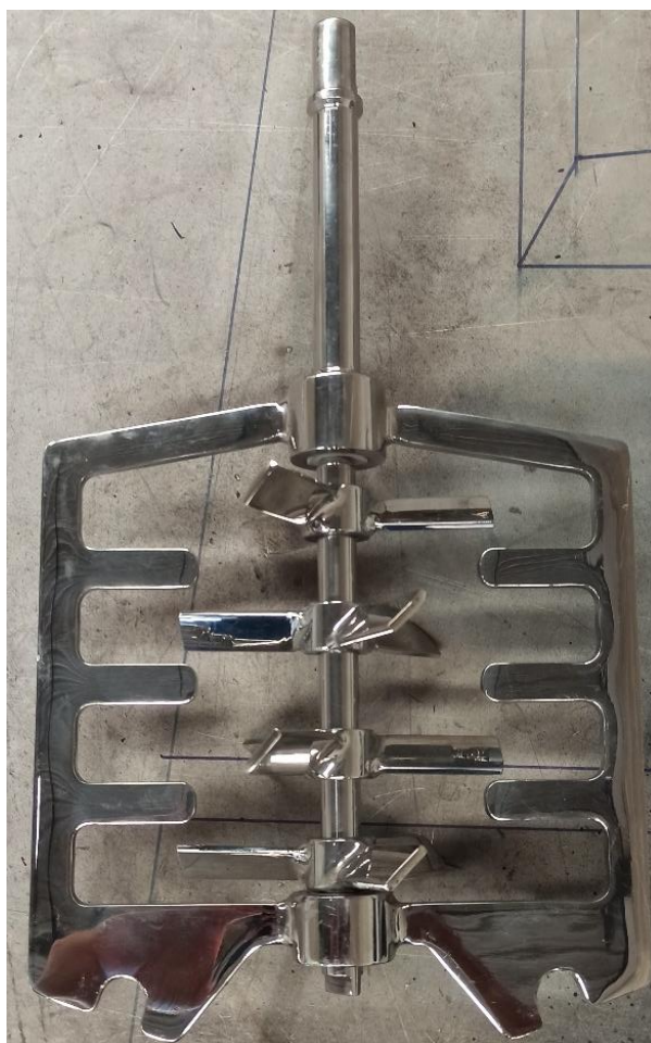
Figura 10: Agitador tipo âncora com hélices.
