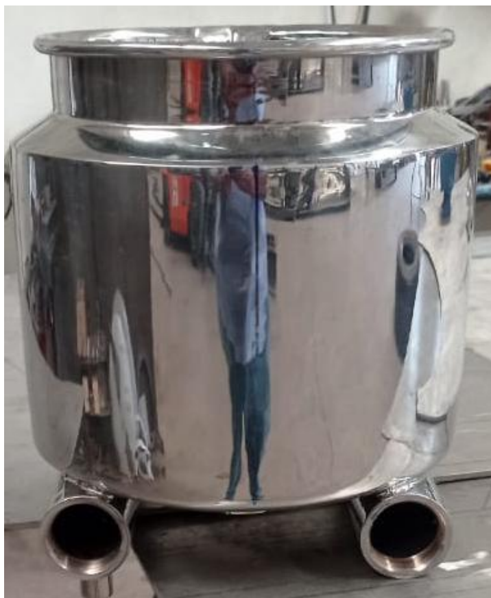
Figura 9: Entrada para resistências.
