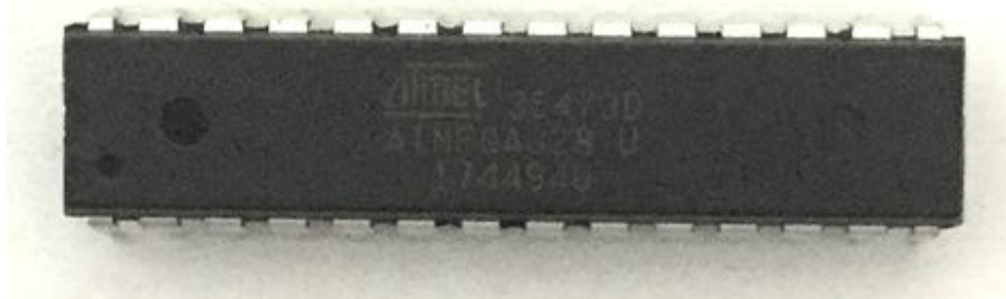
Figura 13: Microcontrolador ATMEGA328p com encapsulamento DIL28.
