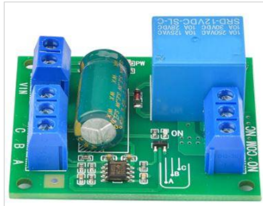
Figura 19: Módulo eletrônico para sensor de nível do tipo eletrodo
