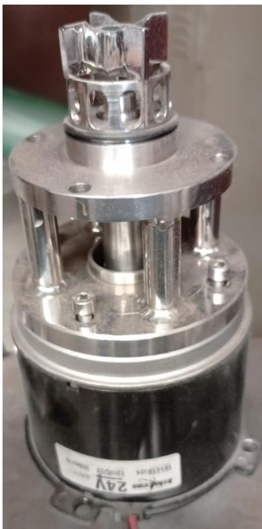
Figura 11: Agitador tipo turbina com motor.
