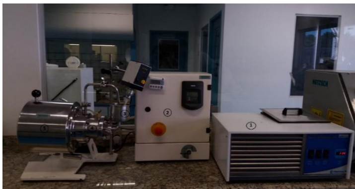
Figura 8: Identificações do Moinho MiniZeta II E (1 – Banho Termostatizado; 2 – Painel de Controle; 3 – Recipiente Coletor; 4 –Câmara de Moenda; 5 –Motor).
