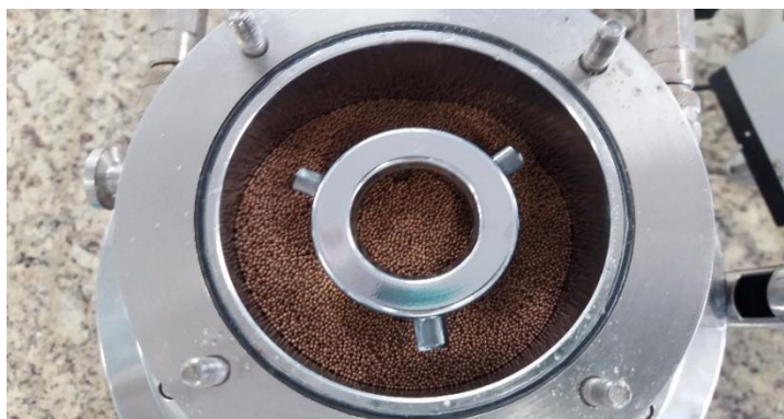
Figura 5: Moinho sendo preenchido com 80% de Esferas de Zircônio.
