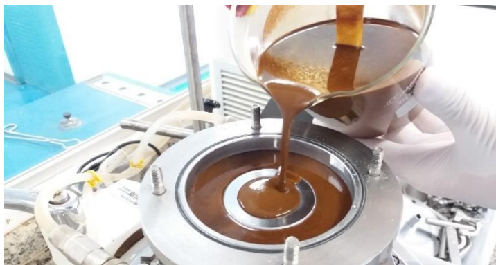
Figura 6: Moinho sendo preenchido com a Formulação de Suspensão Concentrada.
