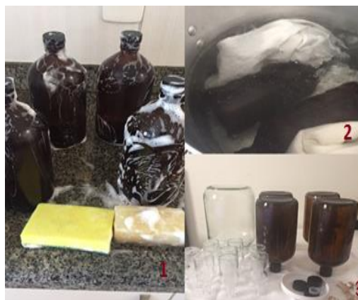
Figura 10- Esterilização do material. 1) limpeza com sabão neutro. 2) fervura. 3) secagem Fonte: Autor, 2017.
