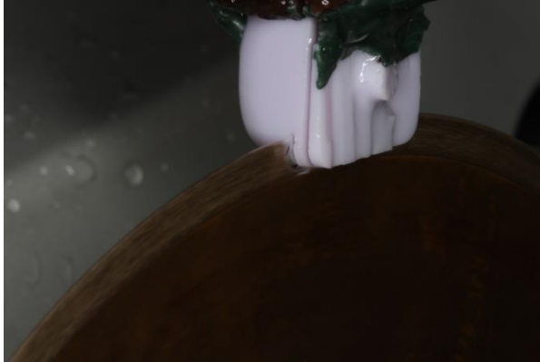
FIG. 10 CORTE DO BLOCO DE CERÂMICA CAD/CAM EM CORTADEIRA DE PRECISÃO COM DISCO DIAMANTADO.
