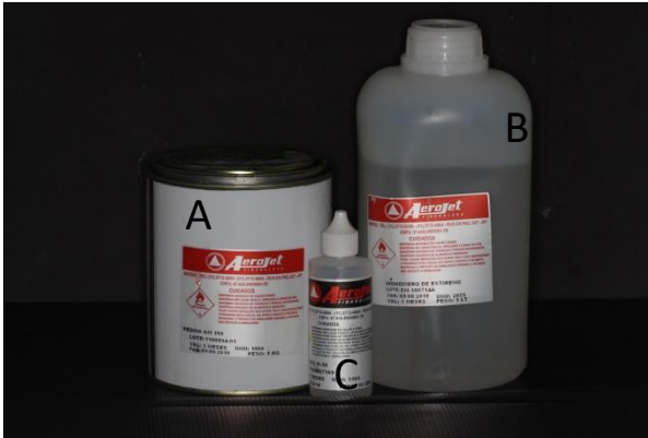
FIG. 35 MATERIAIS UTILIZADOS NA INCLUSÃO DAS AMOSTRAS. A) REINA DE POLIESTIRENO; B) MONÔMERO; C) CATALIZADOR.
