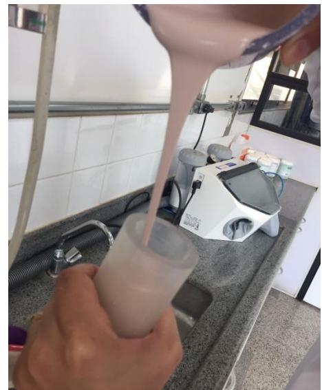
FIG. 4 INSERÇÃO DO REVESTIMENTO NO ANEL DE SILICONE, PREVIAMENTE ISOLADO COM VASELINA SÓLIDA, COM SUAVES VIBRAÇÕES.
