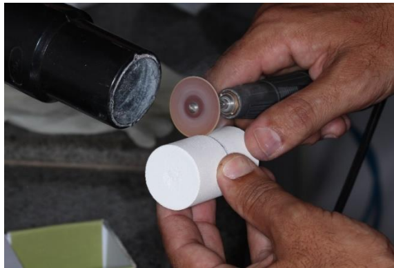
FIG. 7 CORTE DO BLOCO DE REVESTIMENTO PARA DESISNCLUSÃO DAS AMOSTRAS.
