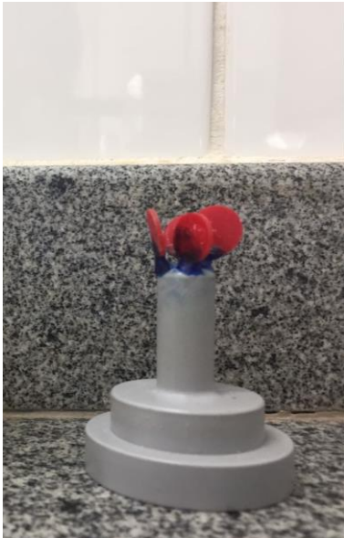
FIG. 1 DISCOS DE RESINA ACRÍLICA FIXADOS COM CERA NA BASE DO ANEL DE SILICONE.
