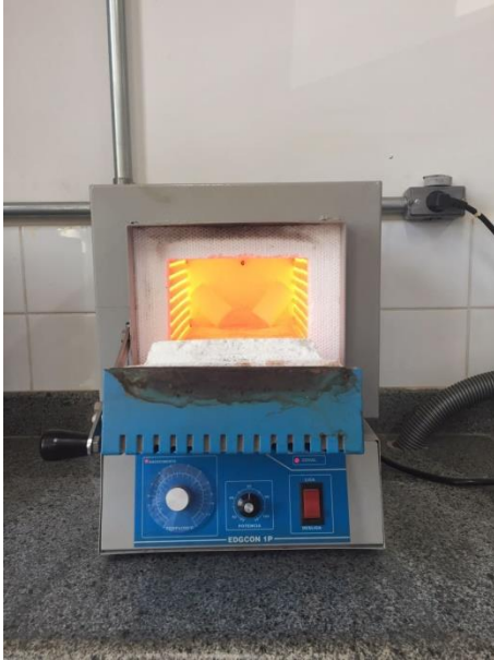
FIG. 5 APÓS A SUA PRESSA, O REVESTIMENTO FOI COLOCADO NO FORNO.
