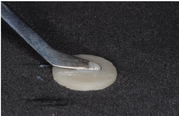
FIG. 29 INSERÇÃO DE CIMENTO RESINOSO NA SUPERFÍCIE DE UMA AMOSTRA PRÉ-TRATADA.
