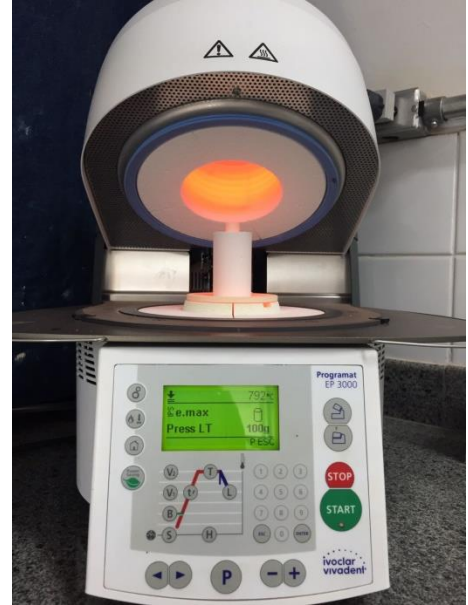
FIG. 6 FORNO IVOCALAR VIVADENT PRENSANDO A PASTILHA DE CERÂMICA PARA O INTERIOR DO REVESTIMENTO.
