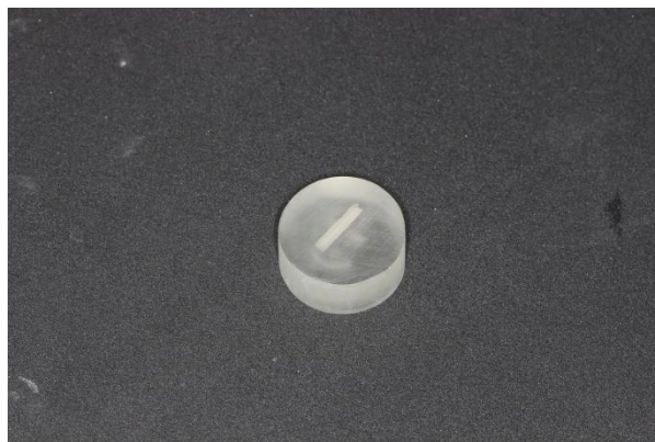
FIG. 37 AMOSTRAS INCLUÍDAS EM RESINA DE POLIESTIRENO APÓS PRESSA DO MATERIAL.
