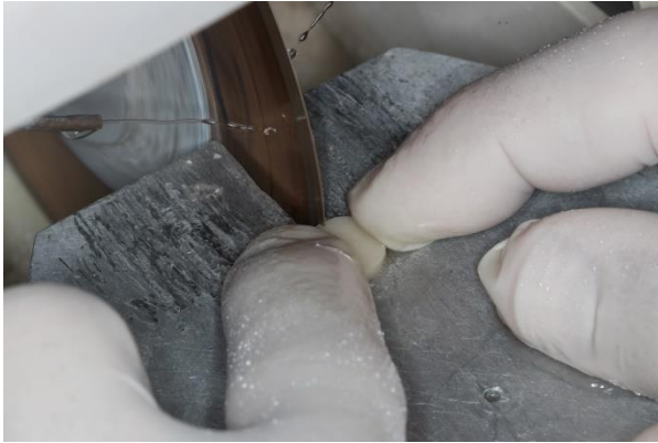
FIG. 33 CORTE DA AMOSTRA EM MÁQUINA DE CORTE COM DISCO DIAMANTADO.
