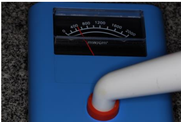
FIG. 23 VERIFICAÇÃO DA INTENSIDADE DE LUZ COM APARELHO RADIÔMETRO.
