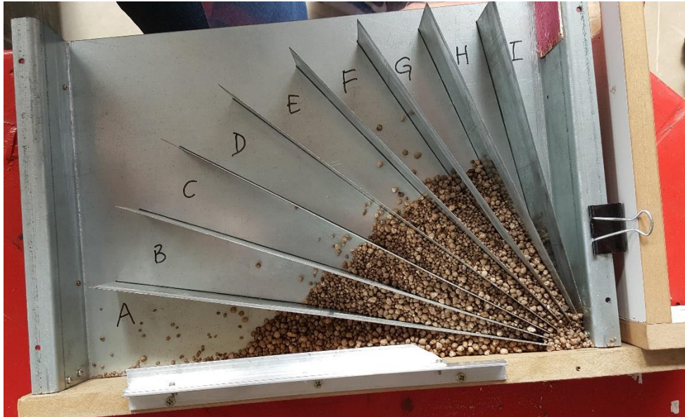
Figura 5.11 – Caixa deitada e com a tampa frontal removida para remoção das amostras de cada região
