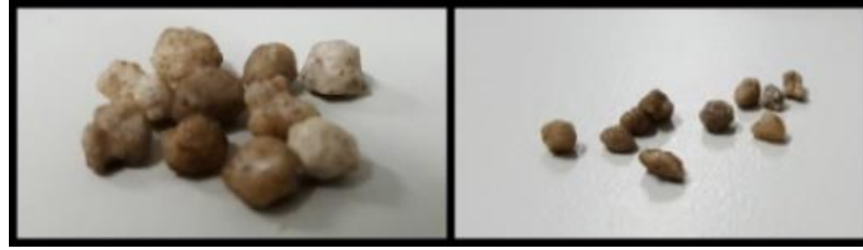
Figura 5.8 – Grupo de 10 partículas de cada amostra para determinação da esfericidade média (lado esquerdo: Amostra A; lado direito: Amostra B)
