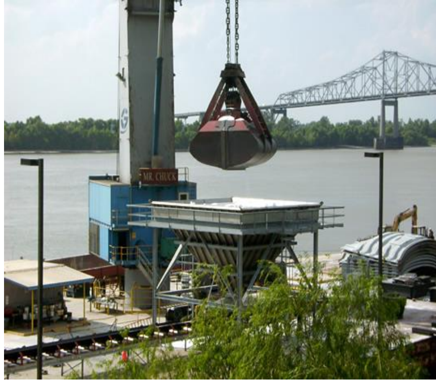
Figura 4.7 – Sistema de descarregamento em porto fluvial numa unidade de mistura NPK (Yargus Manufacturing, Inc. website, acesso 2017)
