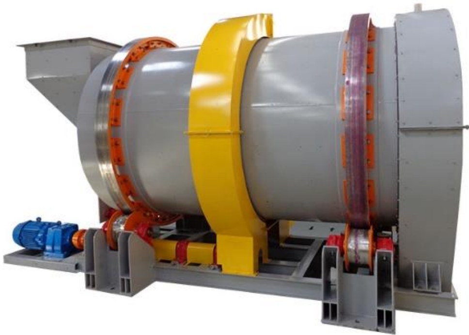
Figura 4.15 – Misturador rotativo (Nippon Máquinas website, acesso 2017)
