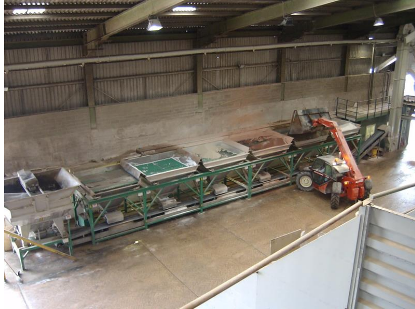
Figura 4.19 – Foto real de uma unidade de mistura contínua – horizontal (EMT website, 2018)
