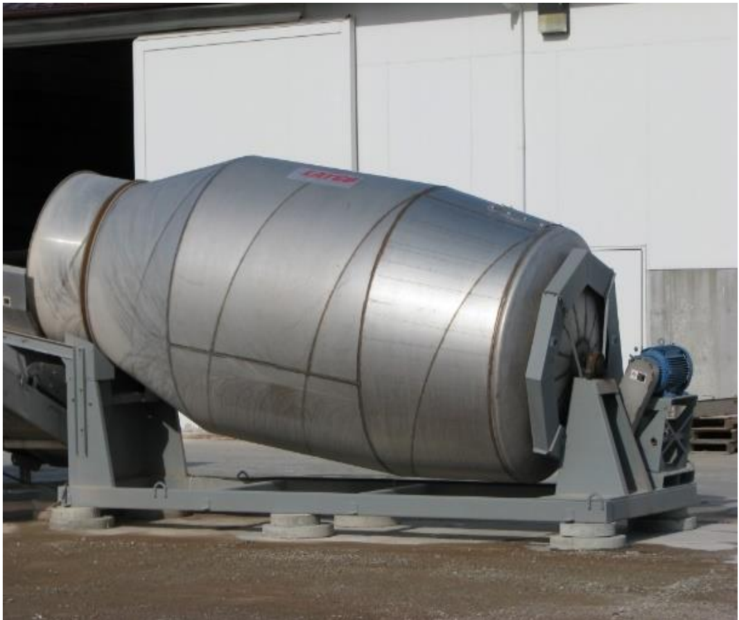
Figura 4.14 – Misturador tipo betoneira (Yargus Manufacturing, Inc. website, acesso 2017)
