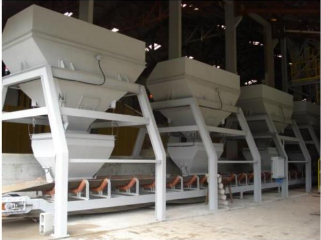
Figura 4.16 – Unidade de mistura a batelada horizontal – moegas de dosagem individuais (Damiani Equipamentos, website)
