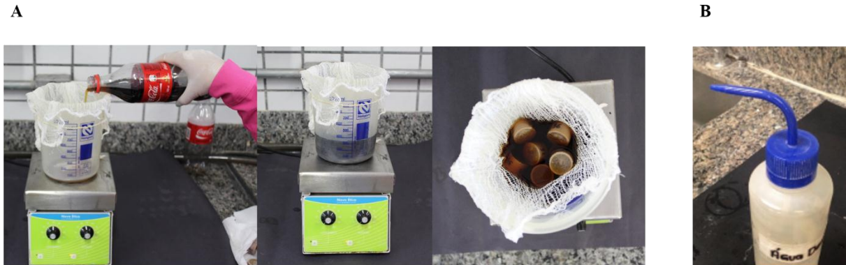
Figura 4. Desafios ácidos. A) Desafios erosivos no agitador magnético. B) Os espécimes sendo lavados com água destilada após cada desafio erosivo.
