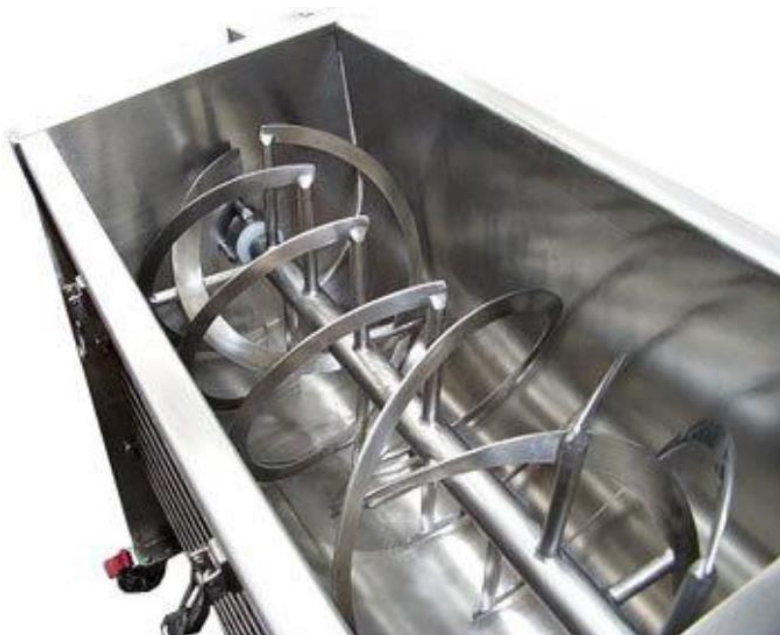
Figura 1. Misturador de fita ( Ribbon Mixer ).
