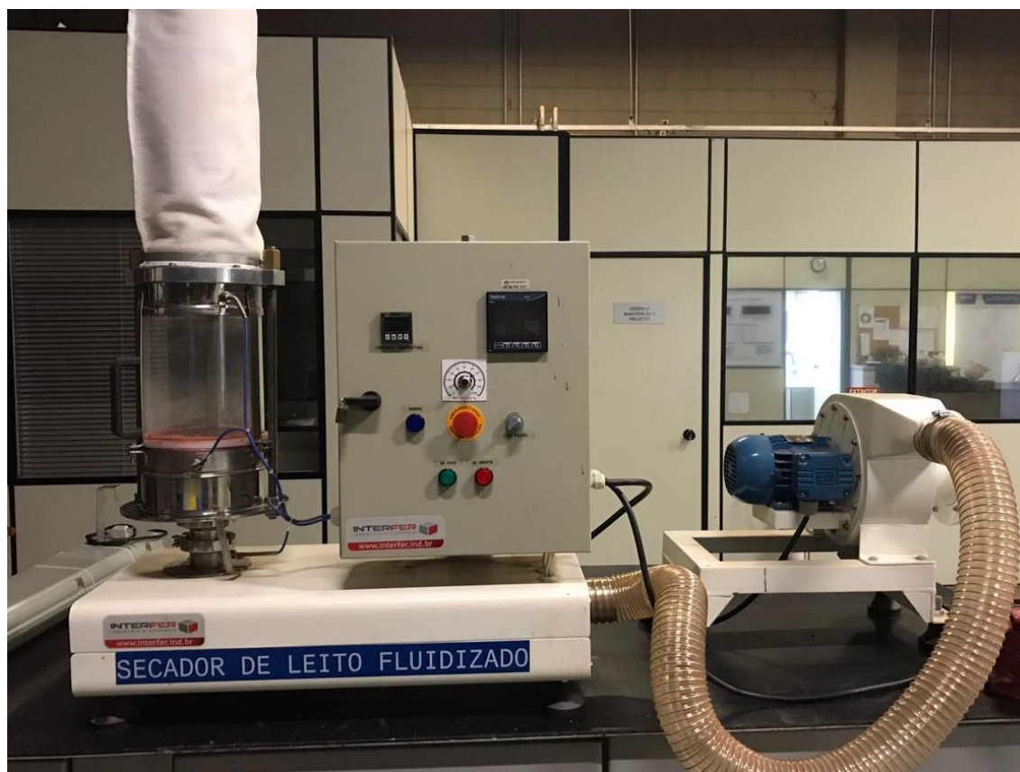
Figura 5: Secador de leite fluidizado de bancada Fonte: Acervo dos Autores.
