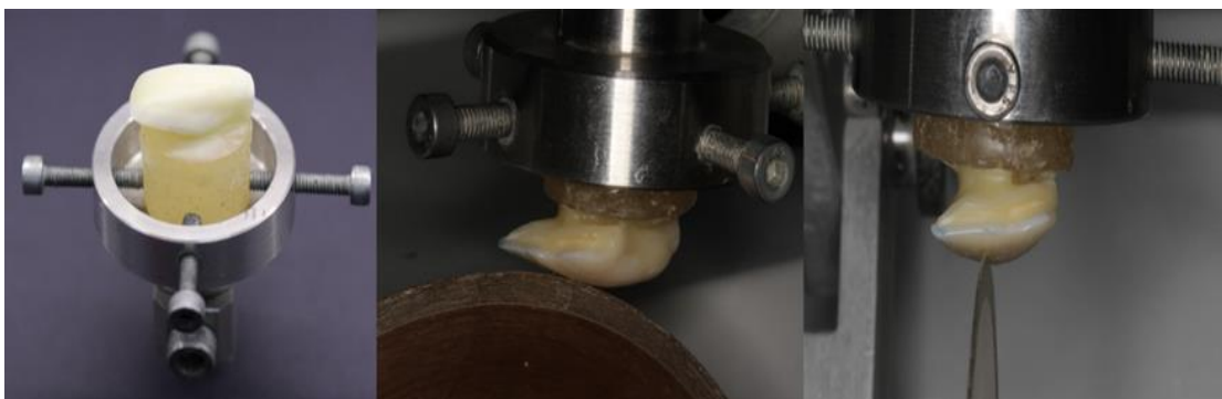
Figura 4: Imagens do processo do acoplamento do cilindro de resina acrílica em uma máquina de corte para a realização de cortes nas medidas 5 mm x 5 mm x 2mm.
