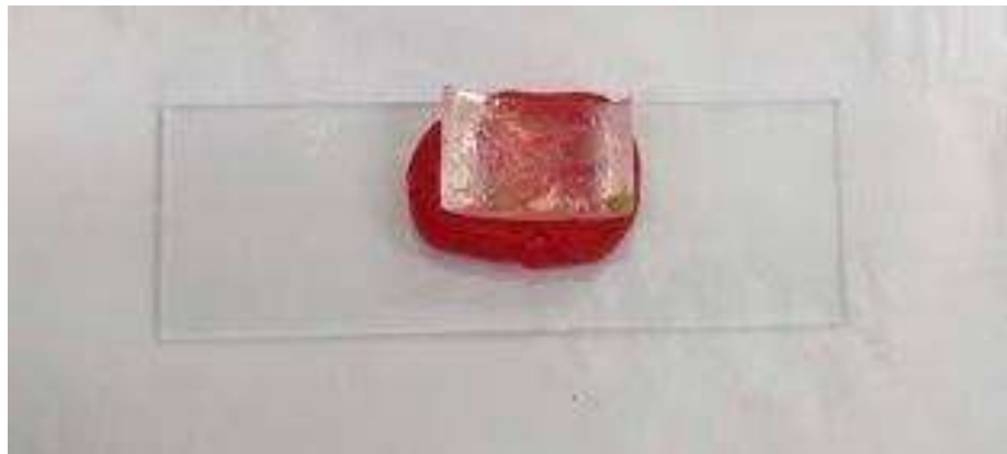
Figura 15: Colocação da amostra paralela à placa de vidro para análise no microdurômetro.
