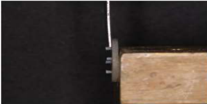
Fig. 18 Posicionamento da amostra em máquina EMIC DL 3000 para teste de cisalhamento. Vista lateral.
