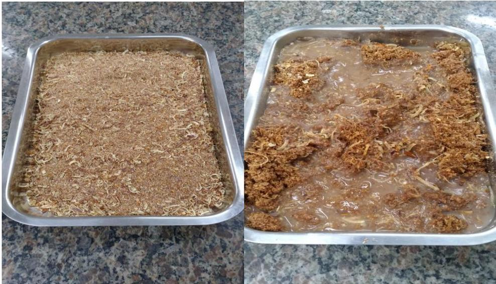
**Figura 18.** A) Formação da manta. B) Adição do adesivo no resíduo madeireiro.
