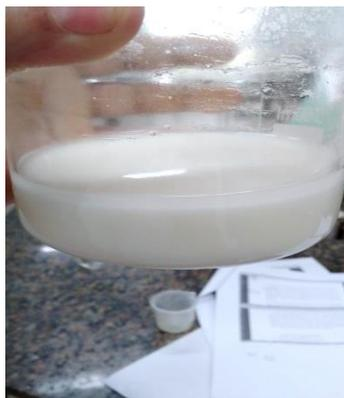
**Figura 25.** Separação de fases - modificação com ácido láctico.
