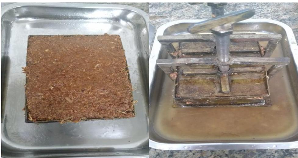
**Figura 19.** A) Inserção da mistura na prensa. B) Prensagem à frio para retirada de umidade.
