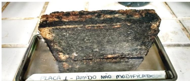
**Figura 22.** Painel formado após prensagem e secagem.
