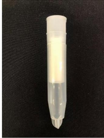
Figura 4: Dispositivo para armazenamento do rolete de algodão
