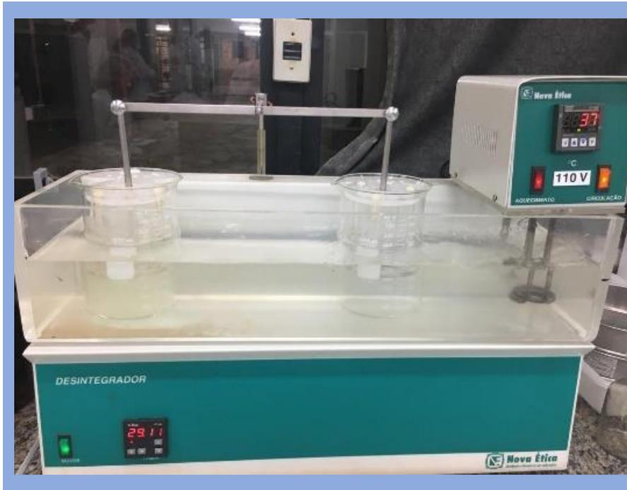
**Figura 4** – Desintegrador
