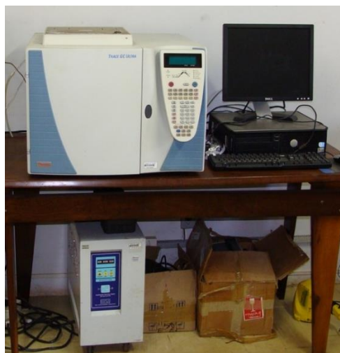
Figura 25 - GC-DCT para análise do gás GNC Fonte: E. U. BUCEK (2009)
