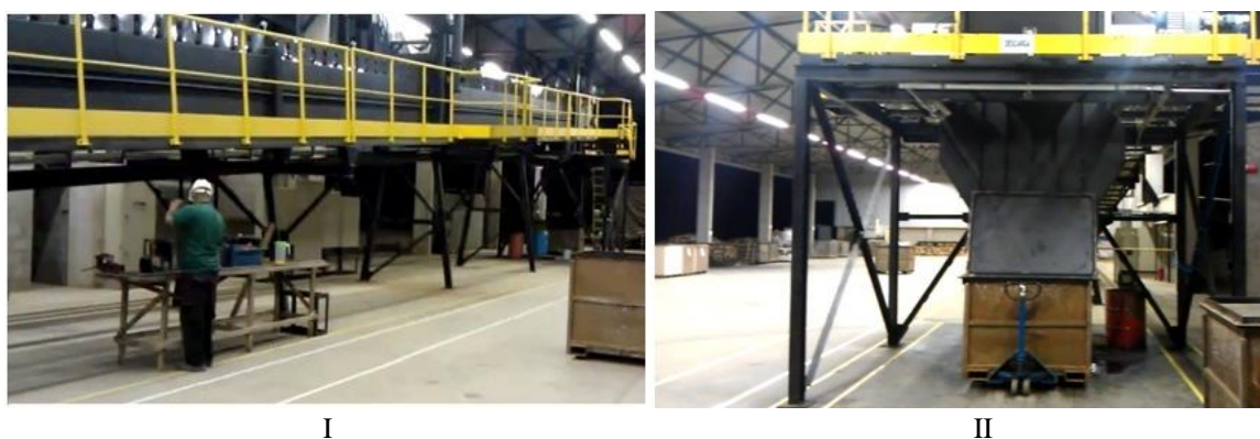
Figura 21 – Vista lateral da cavidade de carbonização (I) e Vista frontal da descarga de carvão (II) da UPEC-250 ONDATEC®
