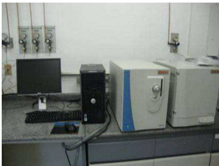
Figura 26 - CG-MS para análise do GC THERMO FISHER SCIENTIFIC® (TSQ 9000) Fonte: (LQCE/ESALQ/USP, 2010)
