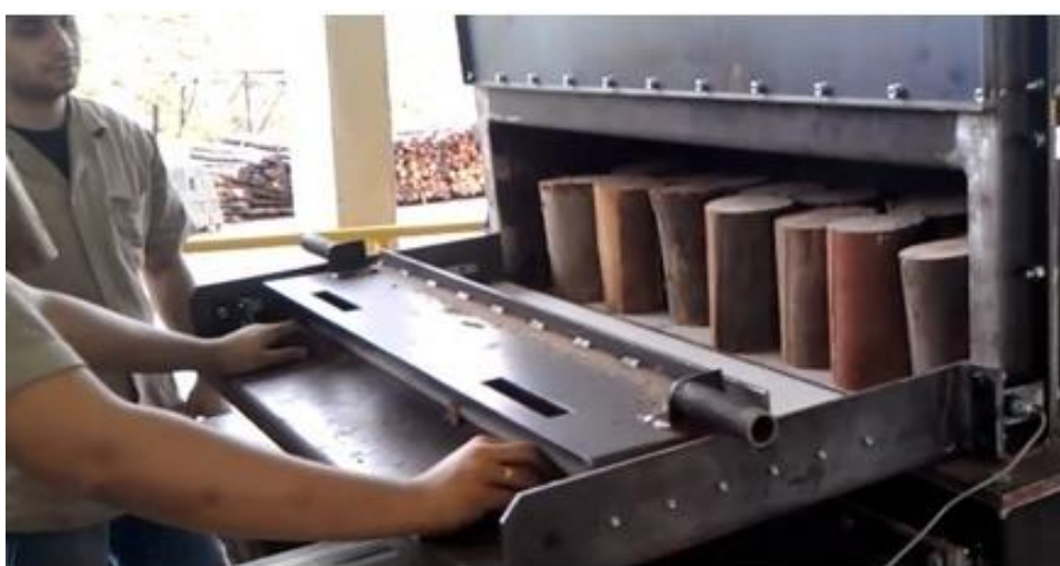
Figura 20 - Sistema de alimentação UPEC-250 ONDATEC® Fonte: ONDATEC – Tecnologia Industrial em Micro-ondas S.A.
