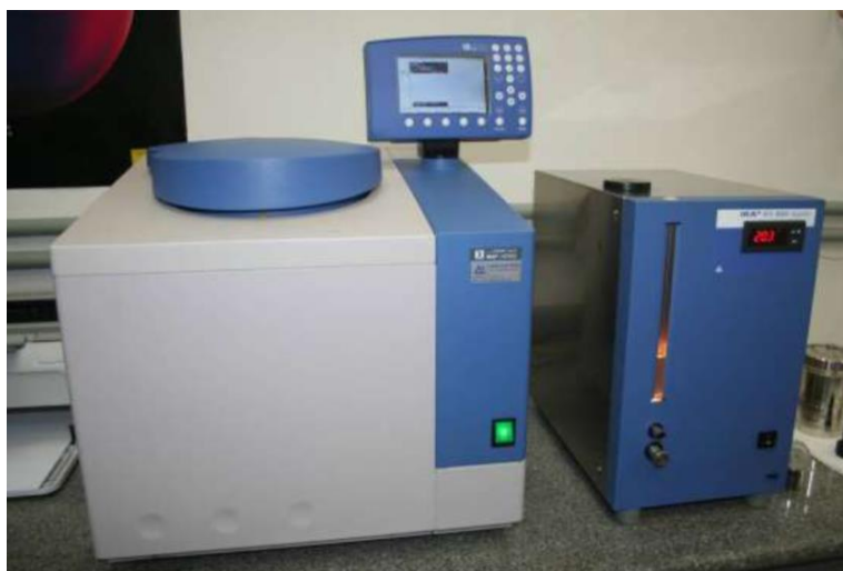
Figura 27 - Bomba Calorimétrica para determinação do PCI do alcatrão marca Ika Works, modelo C2000 Fonte: (LQCE/ESALQ/USP, 2010)
