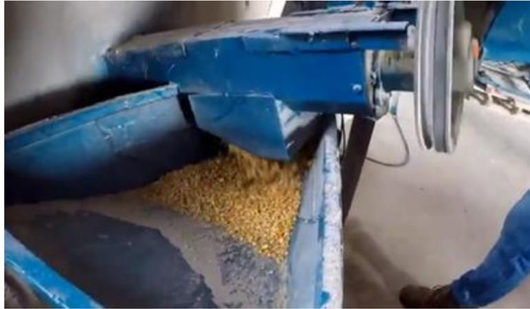
Figura 1: Detalhes do misturador horizontal de matéria-prima.
