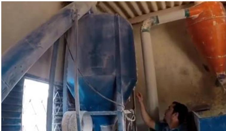
Figura 2: Abastecimento do misturador vertical.
