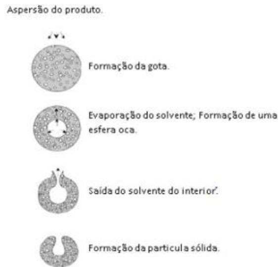
**Figura 2.6:** Formação da microcápsula na secagem por *spray dryer* (SILVA et al., 2014).
