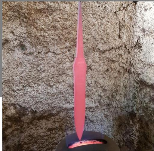
Figura 18 – Lâmina aquecida pronta para resfriamento lento.
