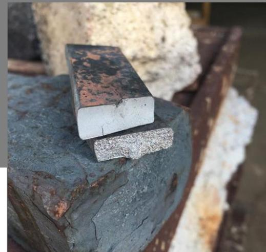
Figura 16 - Aço antes e depois da normalização, evidenciando a diminuição do grão do aço após o processo. OWEN BUSH
