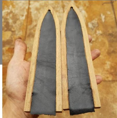
Figura 25 – Bainha de madeira e couro sendo produzida.
