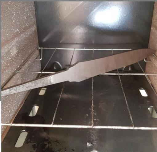
Figura 15 – Lâmina em processo de resfriamento no forno.
