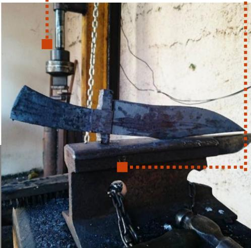
Figura 12 – Peça forjada pronta para o desbaste mecânico. ANTUNES J.
