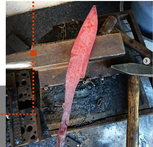
Figura 11- Etapa final do forjamento, onde o aço já foi trabalhado e começa a ganhar a forma da peça em produção. ANTUNES J.
