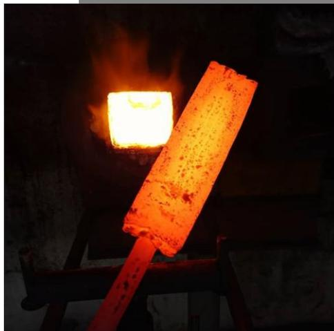
Figura 09 - Aço aquecido na forja, pronto para passar pela modelagem.
