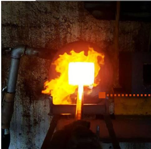
Figura 08- Aço sendo aquecido em uma forja a gás.
