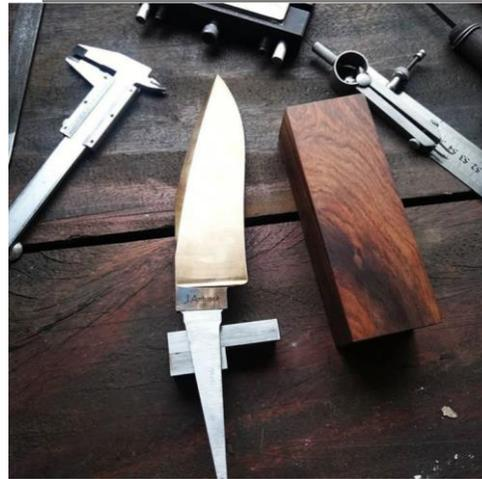
Figura 20 – Lâminas após revenimento e bloco de madeira para cabo. ANTUNES J.
