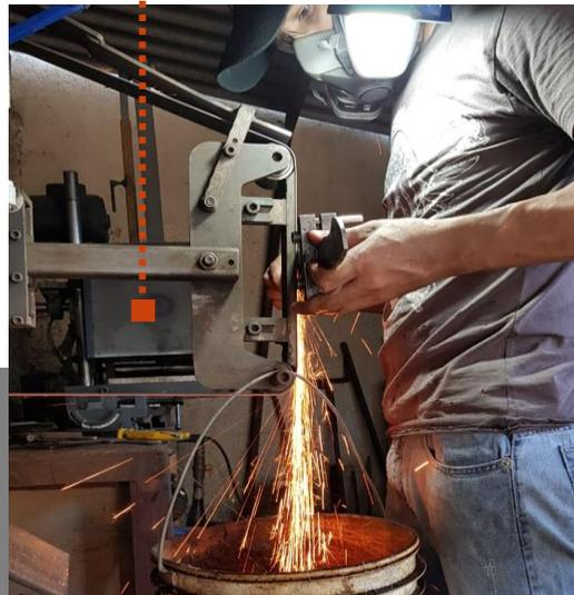
Figura 13 – Desbaste mecânico. ANTUNES J.
