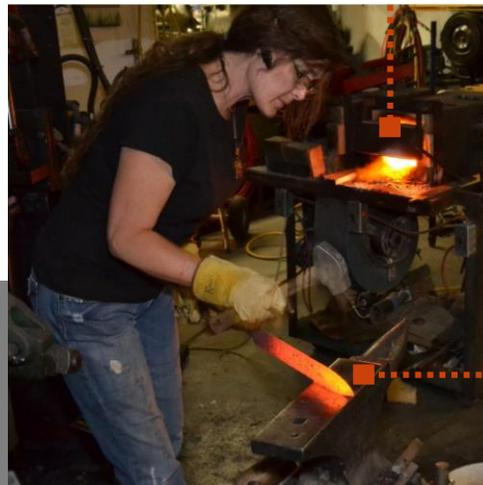
Figura 10 - Audra Draper, modelando o aço aquecido na forja e bigorna.
