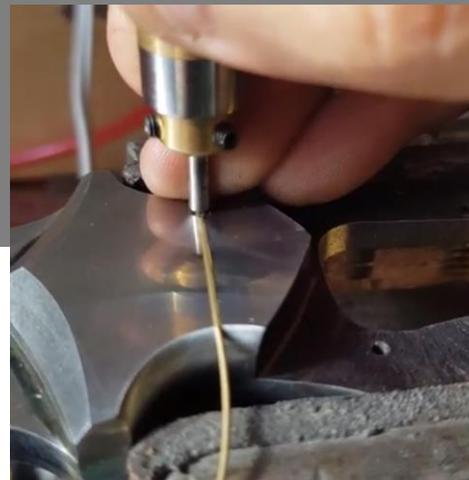
Figura 27 – Detalhe em ouro sendo feito com buril.
