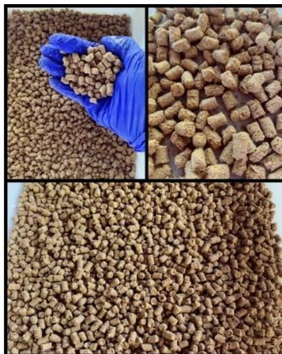
**Figura 30** – Pellets com concentração 100%, provenientes da amostra residual de bagaço de malte (MSM).
