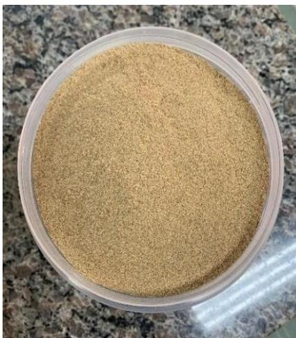
**Figura 17** – Pó proveniente bagaço de malte obtido após a moagem.
