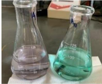
**Figura 23** – Ponto de virada na análise de teor de (PB), após titulação com solução de HCl 0,02 N.
