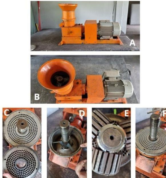
**Figura 32** – Peletizador elétrico, descrição das imagens: A – Equipamento Completo Frente, B – Vista Superior, C – Malhas de Peletização, D – Pá Rotatória, E – Moendas de Compressão, F – Malha de Peletização encaixada em D e E.
