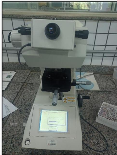
Figura 6: Microdurômetro utilizado na análise de microdureza.
