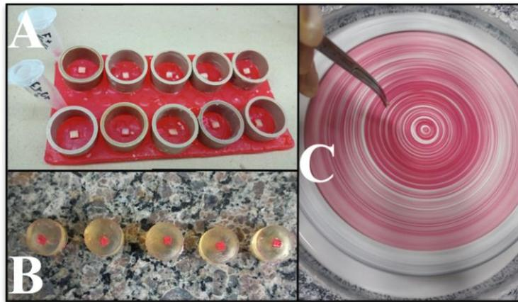
Figura 5: Imagem A e B - Inclusão dos espécimes em resina acrílica transparente. C – Polimento dos espécimes para a realização da microdureza.
