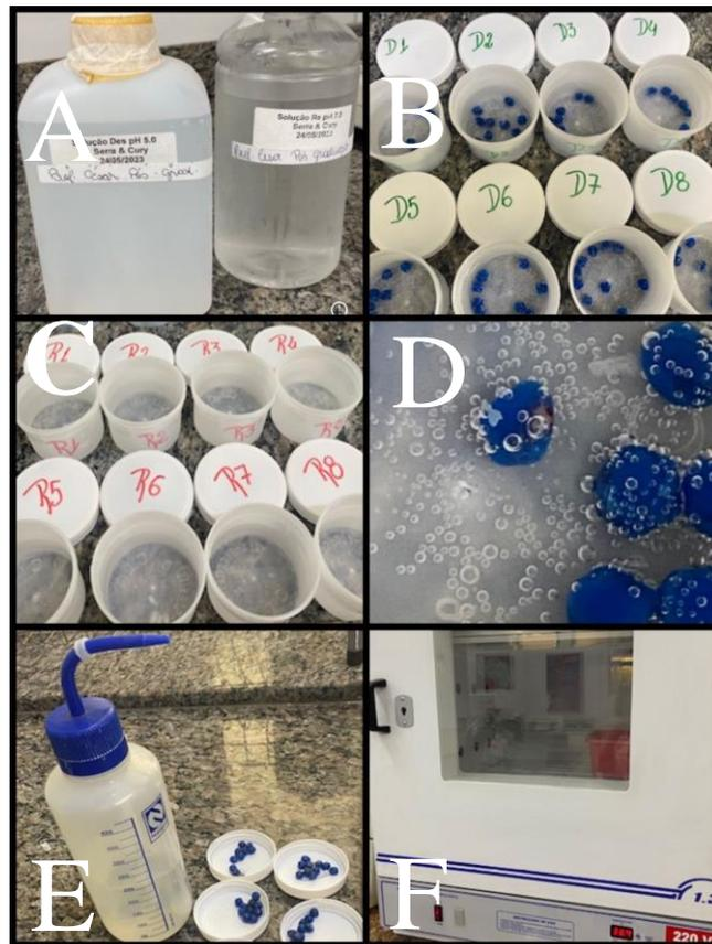
Figura 4: Teste de ciclagem de pH. A – Soluções desmineralizante e remineralizante, respectivamente. B- Recipientes identificados para receber a solução de remineralização. C- Água destilada utilizada para lavar as amostras por 10 segundos e levemente secas com gaze. Os recipientes também foram lavados e secos. D e E– Recipientes com os espécimes imersos na solução desminezalizante em um volume de 50mL. F – Estufa a 37°C.
